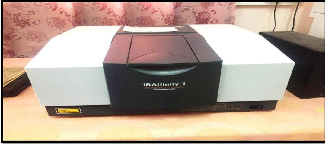
الشكل (18-3): صورة جهاز FTIR
