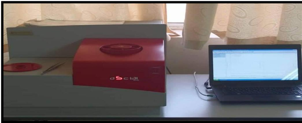
الشكل (3-13): صورة جهاز DSC
