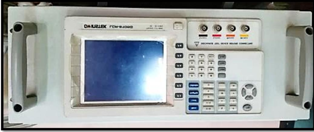
الشكل (3-16) : جهاز اختبار التوصيلية الكهربائية المتناوبة
