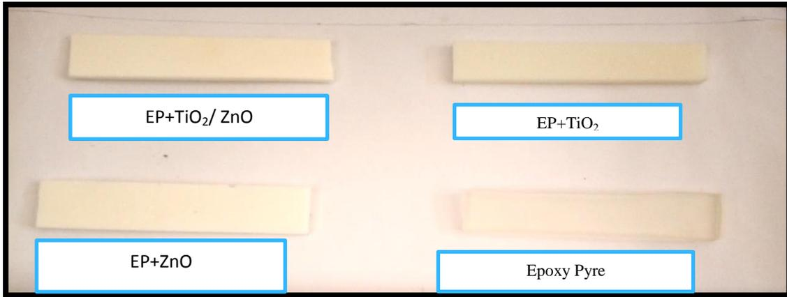
الشكل (8-3): عينات اختبار مقاومة الصدمة
