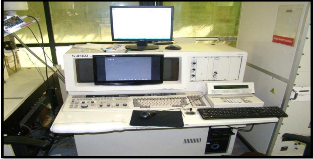
الشكل (3-20): صورة جهاز المجهر الإلكتروني الماسح
