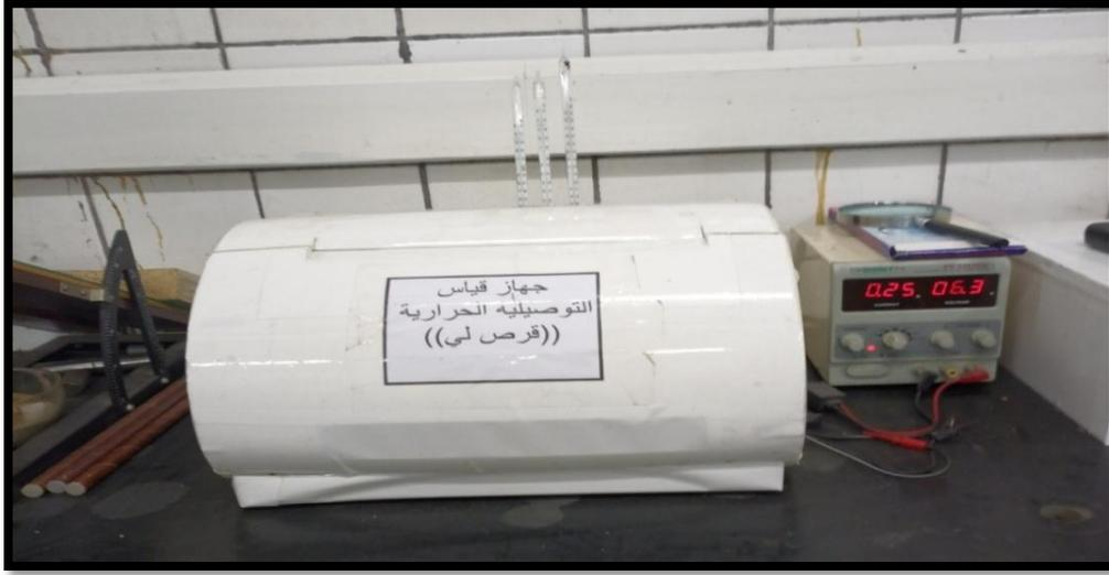
الشكل (11-3): جهاز اختبار التوصيلية الحرارية
