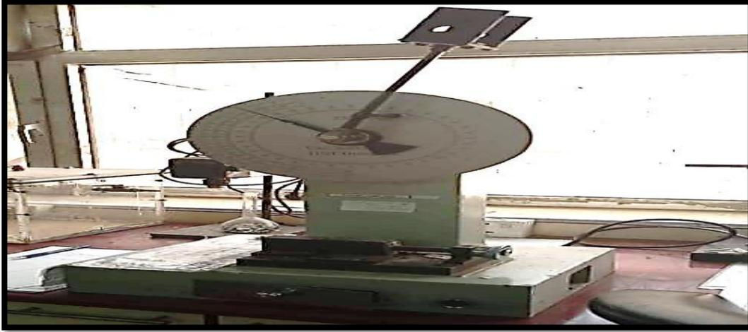
الشكل (7-3): جهاز اختبار مقاومة الصدمة
