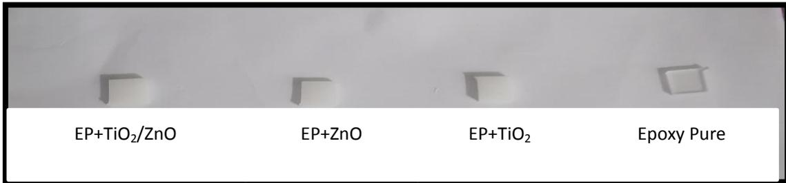
الشكل (3-15): عينات اختبار التحول الزجاجي
